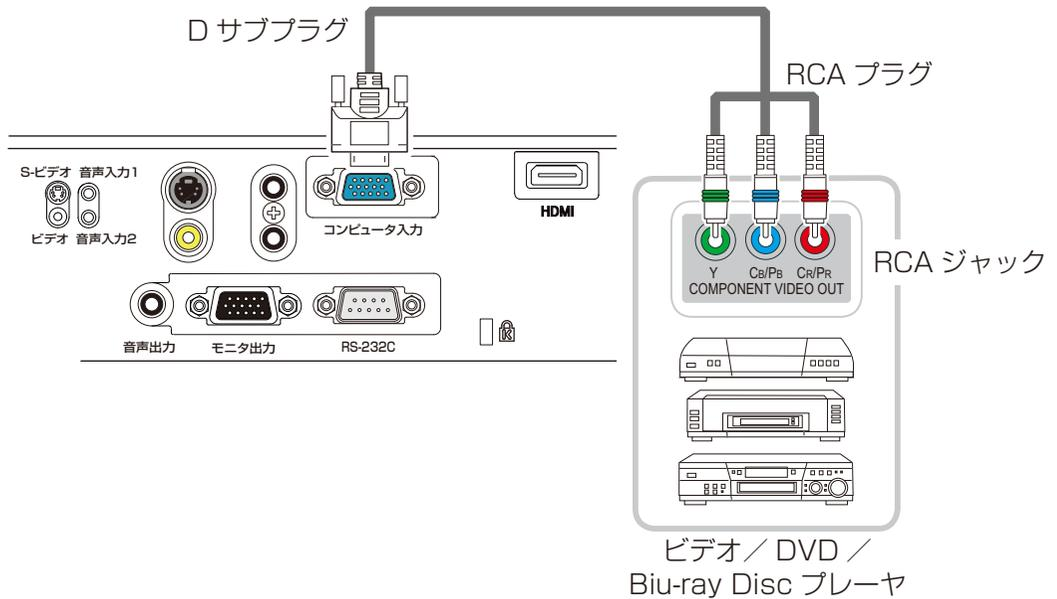
コンピュータ入力端子へのコンポーネントビデオ信号の入力には、RCA-D サブ変換ケーブルまたはアダプタを使用してください。ケーブルまたはアダプタに要求されるピン仕様については、④ コンピュータ入力 (3-4) を参照してください。
