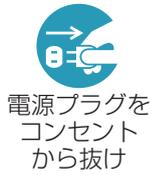
●**エアフィルターをお手入れする前に、電源プラグを抜き、十分冷ます**
