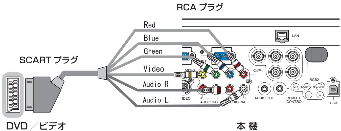
本機に SCART RGB 信号を入力するには、SCART-RCA 変換ケーブルをご使用になり、上図のように接続してください。
