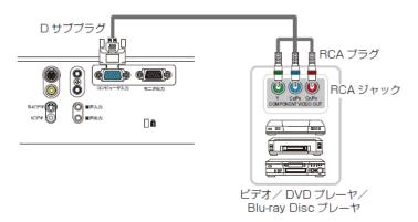
コンピュータ入力端子へのコンポーネントビデオ信号の入力には RCA-D サブ変換ケーブルまたはアダプタを使用してください。
