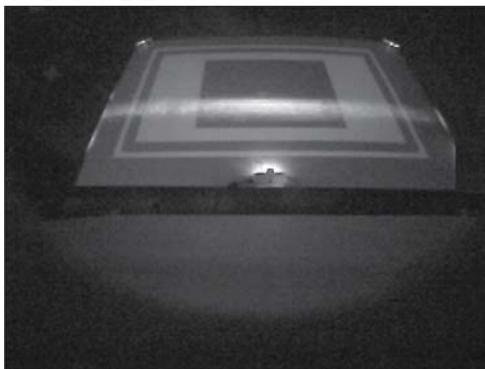
(12) スクリーン右下および左下の調整バーがそれぞれ1点のみ発光するまで、調整ノブ①を時計回りに回してください。
