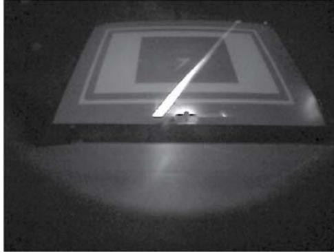
(9) 調整ノブ③を時計回りに回し、Reflection Line を水平にしてください。
