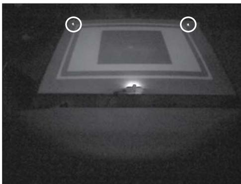
(13) スクリーン右下および左下の調整バーがそれぞれ2点発光するまで、調整ノブ①を反時計回りに回してください。
