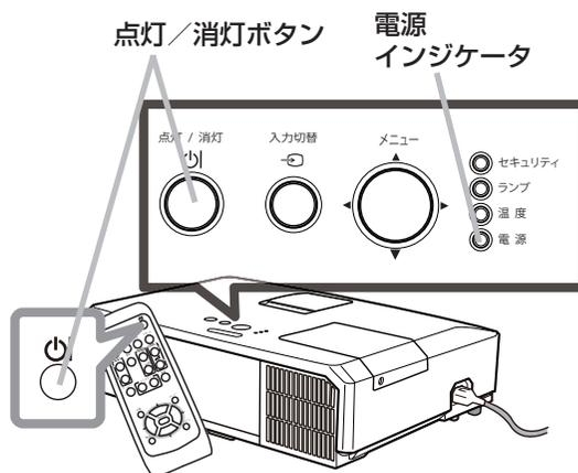
ランプが点灯してから短い時間のうちに電源を切らないでください。また電源を切った後 10 分間は電源を入れないでください。電源の入れたり切ったりを、高温状態で行ったり、短い時間に続けて行ったりすると、ランプが不点灯となったり、ランプの寿命を縮める原因となります。
