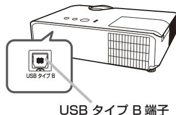
1. 本機の **USB タイプ B** 端子とコンピュータの USB(A) 端子を USB ケーブルで接続します。
