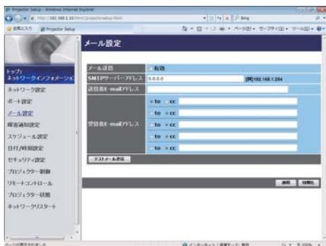
"メール設定" では、"障害通知設定" で指定された、各エラー／警告の通知を行うための電子メールの設定を行います。
