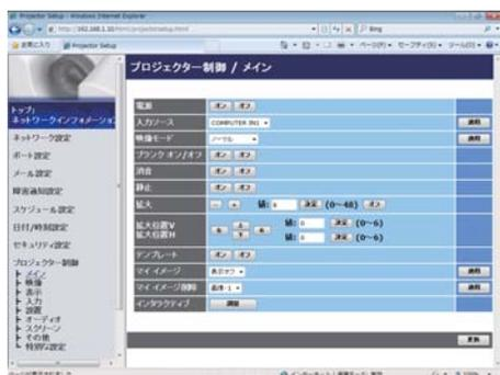
“プロジェクター制御”では、本機の設定状態を表示し、また、本機を遠隔操作することができます。制御メニューを選択すると、制御メニューごとの設定画面が表示されます。
