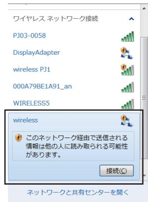
7) 接続が成功すると、SSID の横に "接続" と表示されます。
