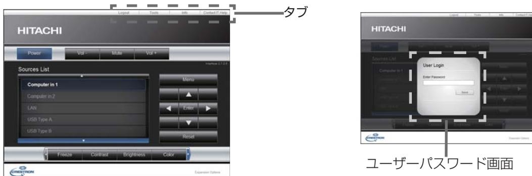
選択画面で [Crestron e-Control] を選択すると、上図のメイン画面が表示されます。ただし、Tools 画面で "User Password" を有効に設定しているとき、上図右のように、パスワードの入力を要求するダイアログが表示されます。設定したパスワードを入力すると、メイン画面が表示されます。メイン画面の右上にあるタブをクリックすると、以下の各画面に表示を切り替えることができます。
