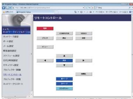
メインメニューの[リモートコントロール] をクリックすると、左の“リモートコントロール”画面が表示されます。“リモートコントロール”では、本機付属のリモコンのイメージで本機を操作できます。
